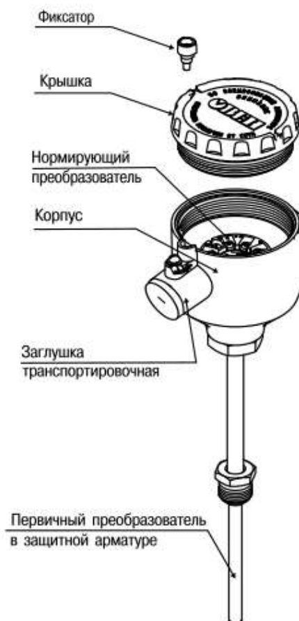
Рисунок 3.1 – Устройство датчика
